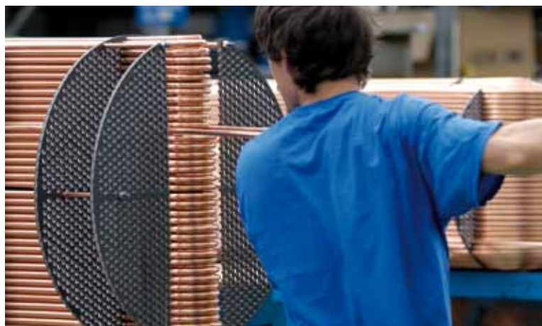
Mounting operation of shell and tube evaporators with increasingly bigger diameters and capacities. Montaż wiązek rurowych o coraz większej średnicy i mocy.
