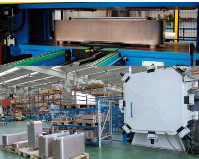
In the new fully automatic test machine the brazed plates heat exchangers are tested for a working pressure up to 30 bar (45 bar for the H version). W nowej pozycji kontroli technicznej całkowicie zautomatyzowanej płyty zostają testowane przy ciśnieniu roboczym aż do 30 bar i, w wersji H, aż do 45 bar.
