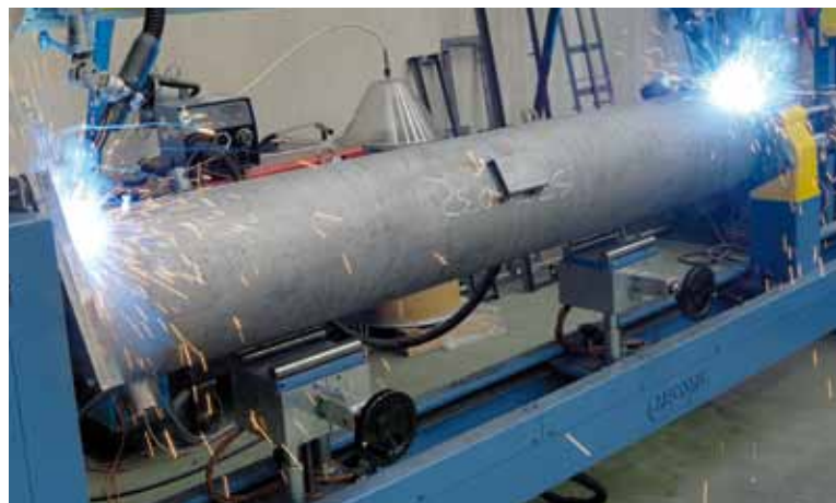
Automatic welding machine / Spaw zautomatyzowany
